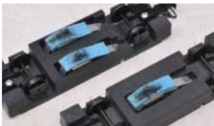
Die Vliese nach etwa 250 Metern Fahrt: gut verschmutzt, Austausch fällig.
