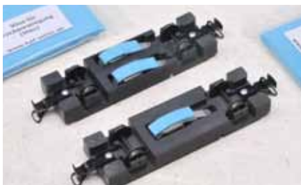
Kleine mit Doppelklebeband befestigte Streifen Aldi-Putz Tuch bilden das Reinigungsvlies.
